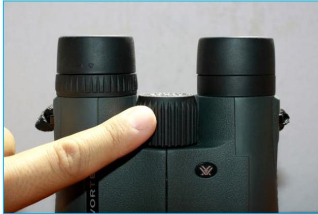
**Figura 5. Ajuste con anillo de enfoque para el ojo izquierdo.**
