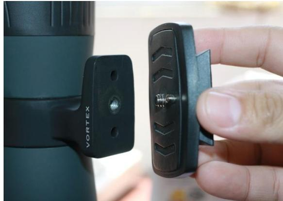
**Figura 8. Colocación de la zapata del tripié en el telescopio terrestre.**
